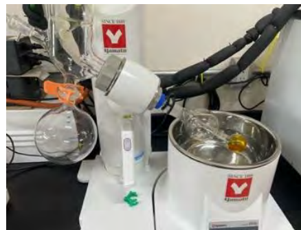
Figura 6. Evaporación de las fracciones utilizando un rota vapor para separar el solvente.
