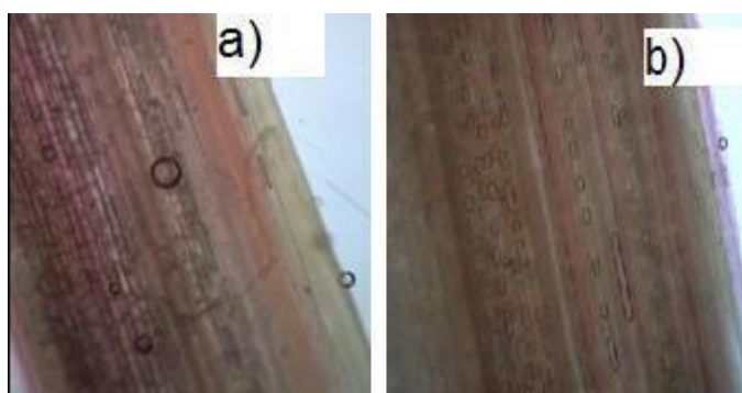
Figura 4. Micrografía de fibra de Arundo donax con tratamiento alcalino 0.5 M (a) y 2 M (b) de NaOH.
